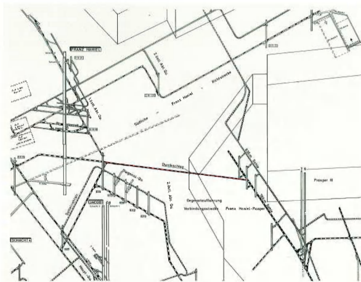
Abb. 1: Verbindungsstrecke auf der 5. Sohle zwischen Franz Haniel und Prosper
