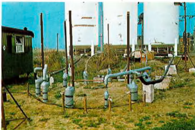
Abb. 1: Versuchseinrichtung vor Beginn der Vereisung. Im Hintergrund die Behälter mit flüssigem Stickstoff.
