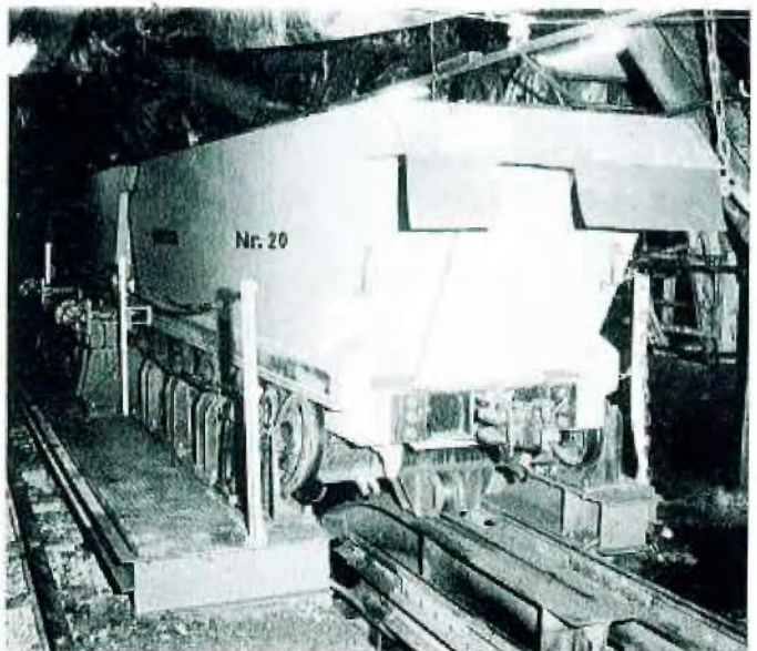
Abb. 2: Zugeinheit beim Überfahren des Rohkohlenbunkers
