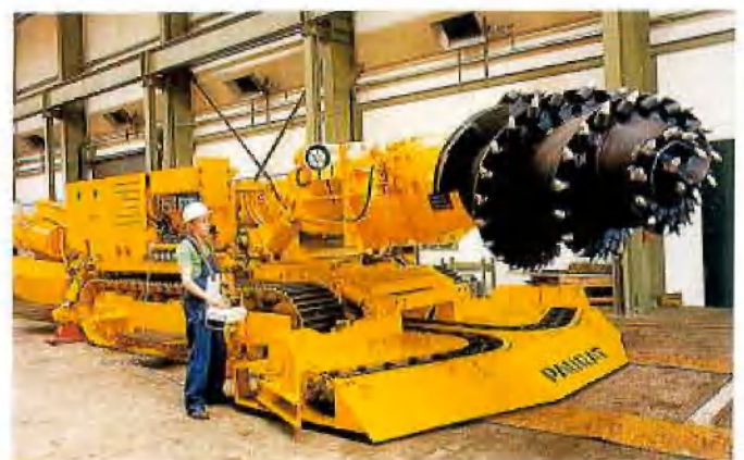
Abb. 6: Roboter-D der Firma Paurat
