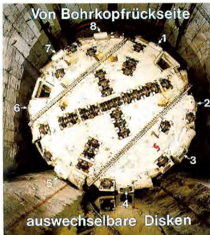
Robbins-Strecken-vortriebsmaschine in der Montagekammer: Ansicht des flachen Bohrkopfes
