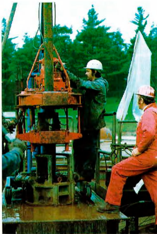
Abb. 5: Hydraulisch betriebene Weatherford-Zange mit Kontereinrichtung
