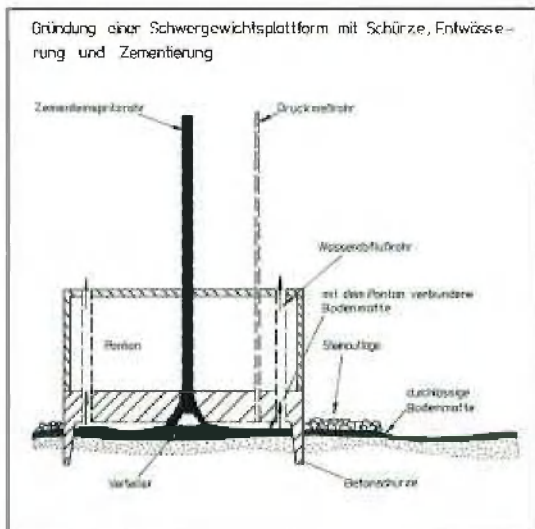
Abbildung 3: Gründung einer Schwergewichtplattform
