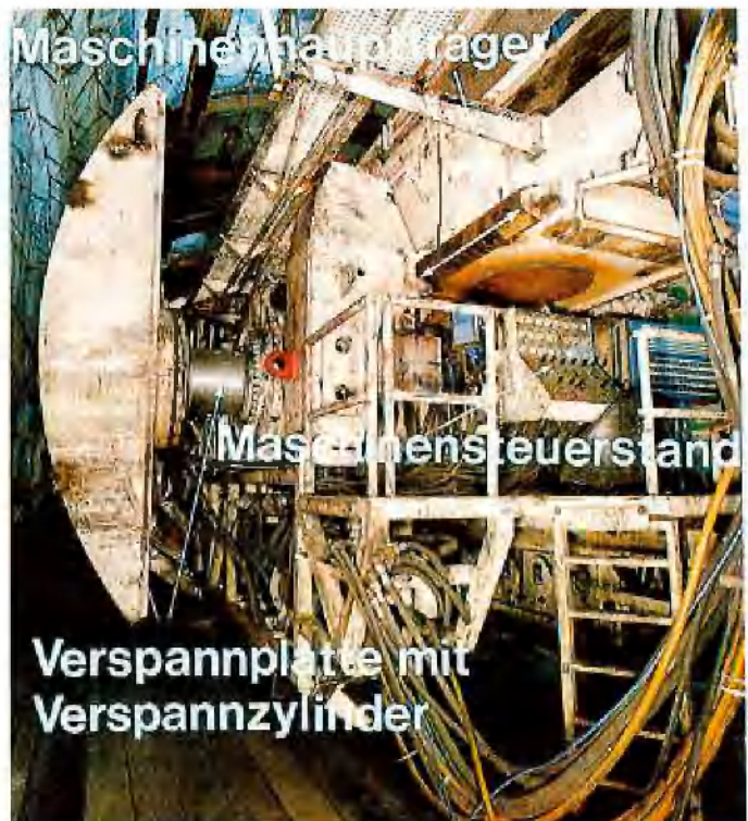
Robbins-Strecken-vortriebsmaschine in der Montagekammer: Ansicht der Maschinenverspannung und des Steuerstandes
