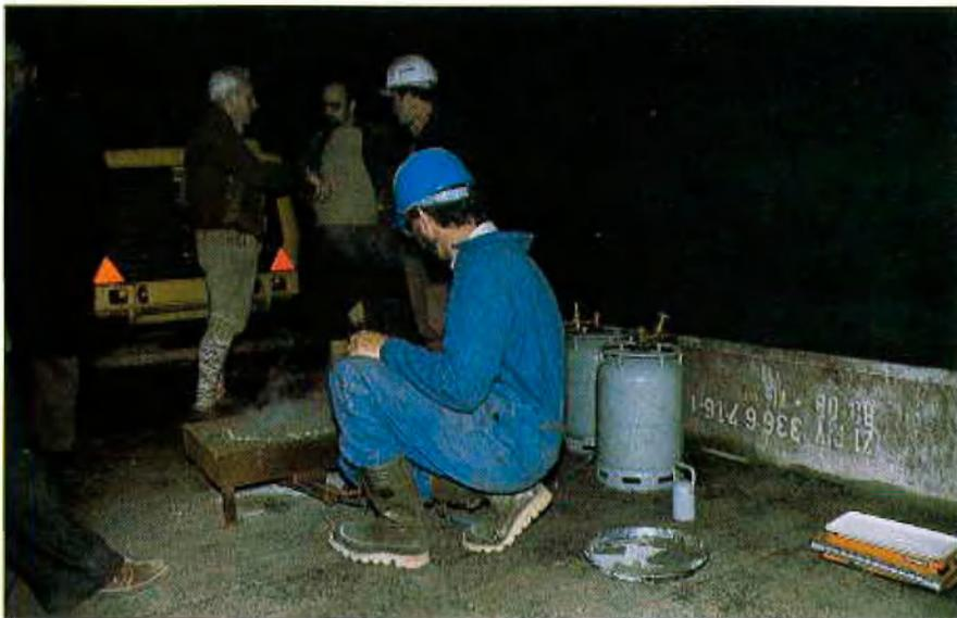
Abb. 6: Rückprallanalyse mit Darrgerät
