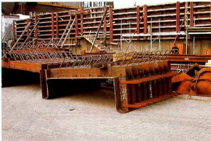
Abb. 6: Zylinderschütz mit Klapptornische und Oberhaupt
