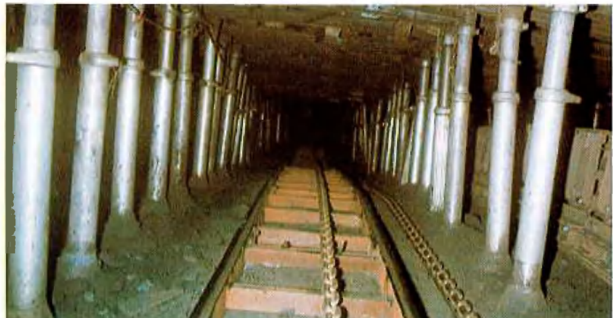
Abb. 3: Einfahrgasse Herrichtungsstreb. Transporttrumm mit Kulibahngestänge zur Führung des Transportschlittens, vom Fahrtrumm getrennt.
