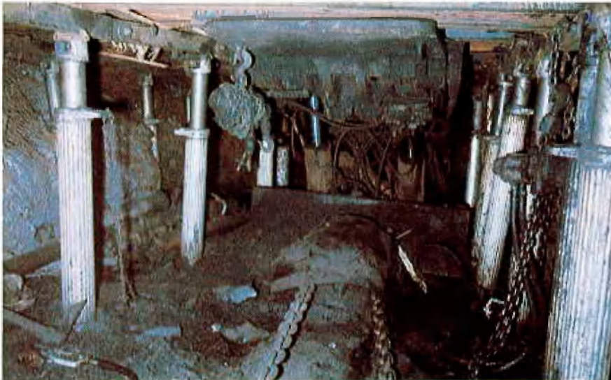
Abb. 4: Raubschild: Sicherung des Raubortes und Schwenkraumes. Führungsschlitten als Widerlager für die Umkehre der Strebtransporteinrichtung. Rauben der Hydraulik-Einzelstempel vom sicheren Standort aus.
