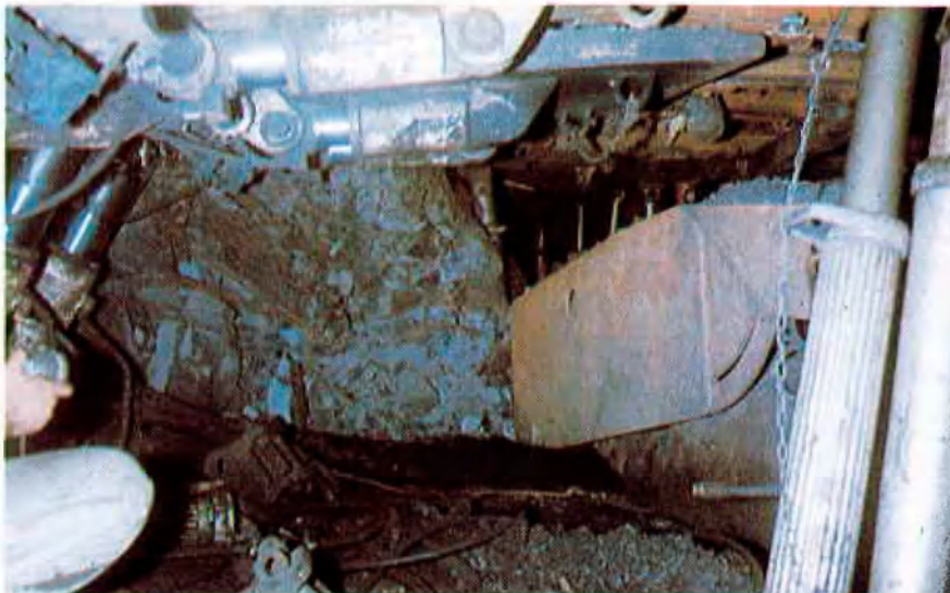
Abb. 5: Vorziehen und Schwenken des Schildes.
