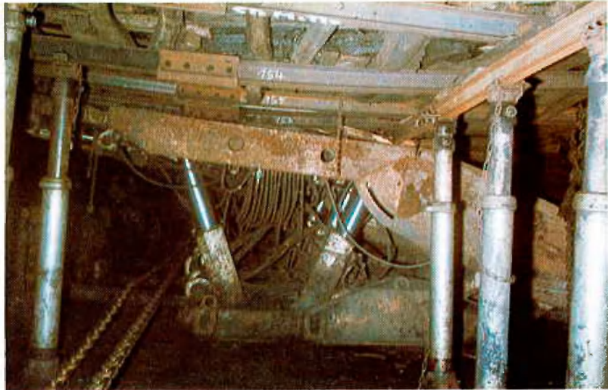
Abb. 13: Schild eingeschwenkt und unter Druck.
