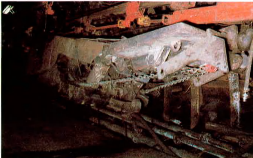
Abb. 6: Schild beim Vorziehen und Schwenken aus der Raubstellung in die Transportgasse.
