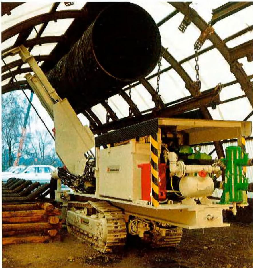
Ankerbohrwagen für das Einbringen von Einzel- und Doppelankern beim Probelauf in „Flöz Sonnenschein“ in Kurl
