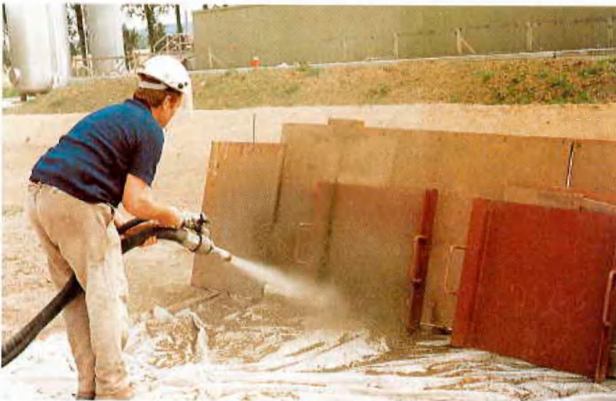
Abb. 7: Herstellung der Probeplatten für die Güteprüfung
