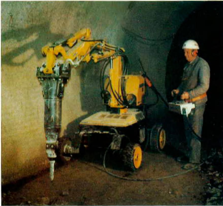
Hydraulischer Felsmeißel auf Kleingerät
