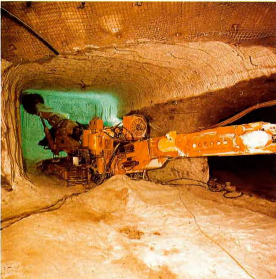
Ausbau-Verbundsystem ist der kraftschlüssige Anschluß des Ausbaus an das Gebirge durch einen Stützschlauch.
