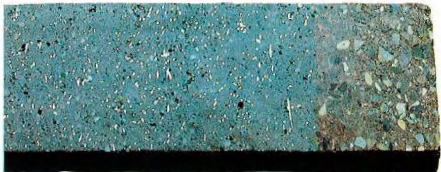
Die besondere Formgebung der 18 mm langen Stahlfasern bewirkt eine verbesserte Verankerung im Densitmörtel bei gleichzeitiger Mini- mierung der Verletzungsgefahr.
