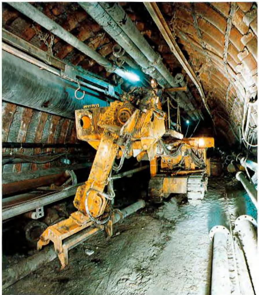
Abb. 7: Rohreinbaugerät bei der Aufnahme eines Rohres auf der Streckensohle
