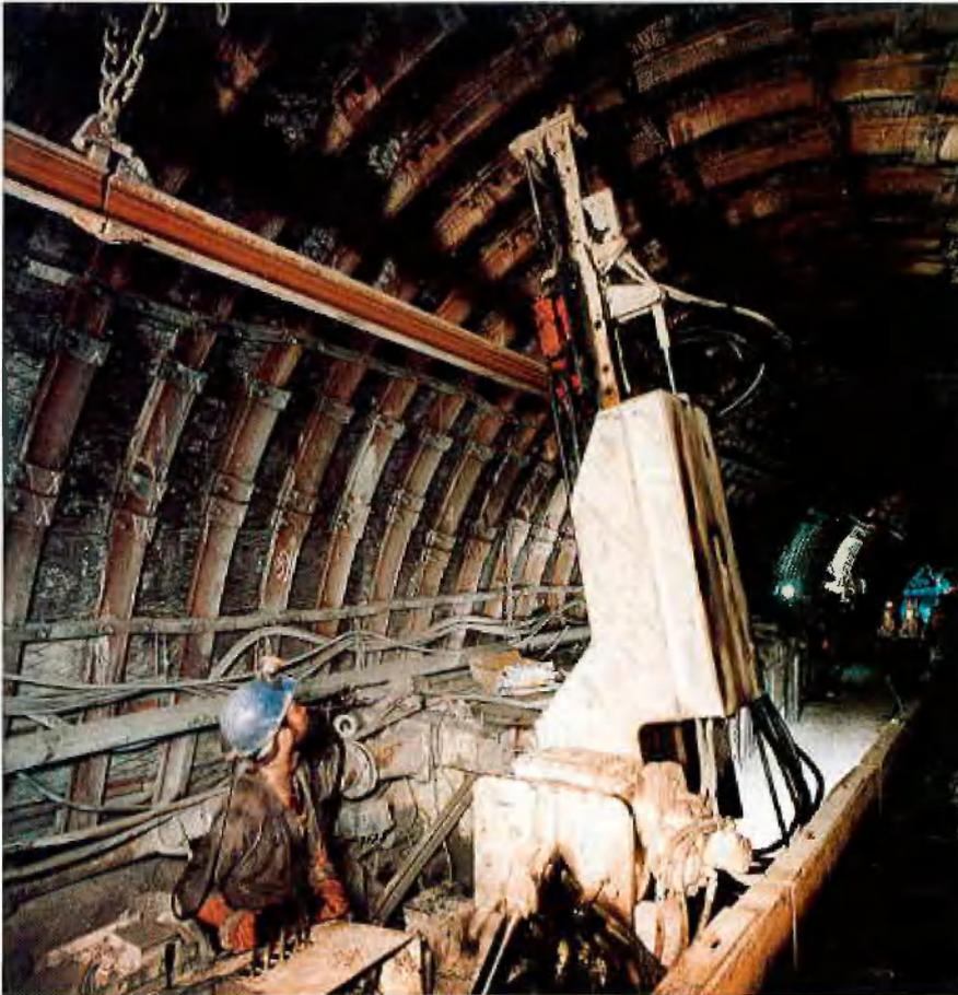
Abb. 5: Ankerbohrwagen zum Einbringen von Gebirgsankern
