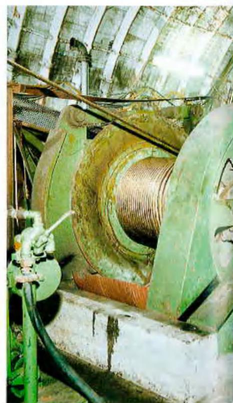
Bühnenwinde und Doppelbobine auf der 4. Sohle
