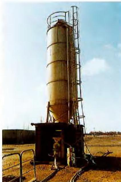
Abb. 6: Spritzbetonförderanlage
