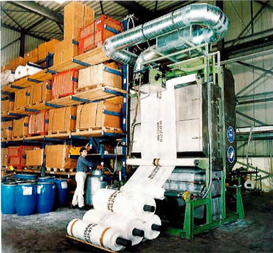
Abb. 3: Tränk- und Trocknungsanlage für das GKG-Terram-Vlies
