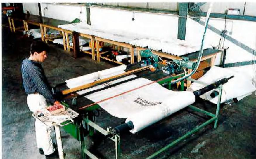
Abb. 4: Die neue Anlage für das gegenläufige Wickeln der Vliesbahnen
