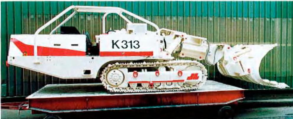
Seitenkipplader mit Schutzaufbau
