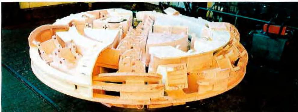
Bohrkopf für die Evinos-Tunnelbohrmaschine
