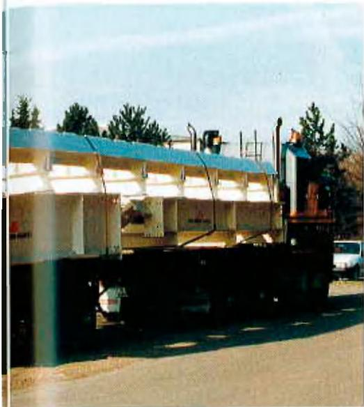
Als Nachläufer einer Tunnelbohrmaschine bezeichnet man die Zusammenfassung und Installation aller für den Betrieb der Bohrmaschine notwendigen Aggregate und Einrichtungen.
