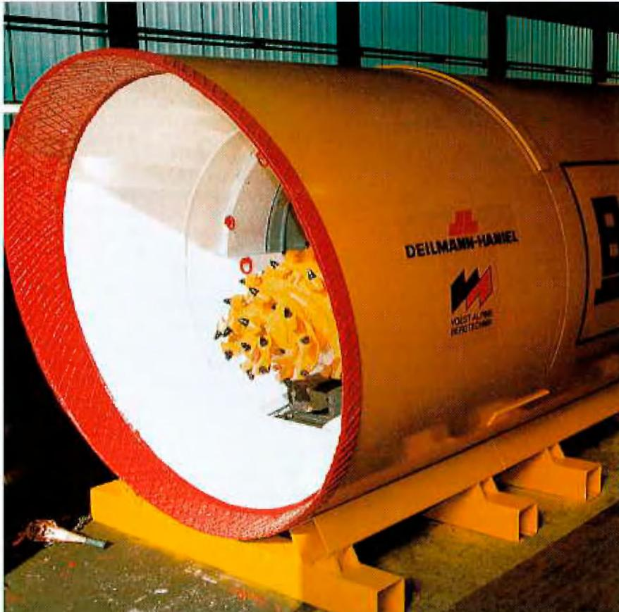
Bohrkopf und Schneidschuh in der DH - Werkstatt
