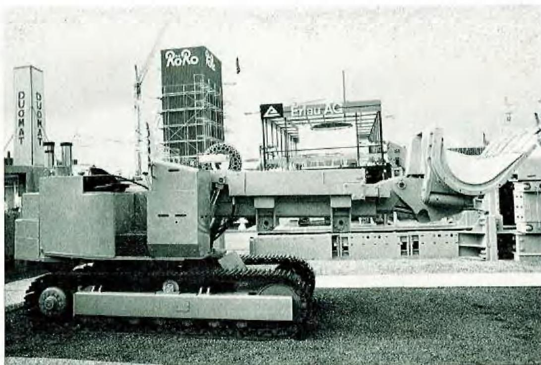
Unter den Ausstellungsstücken der Firma A. Wirth & Co., Erkelenz, dominierte ein Großbohrkopf, der zu einer 65 t schweren Gesenkbohrmaschine für Erweiterungsbohrungen bis 5 m  $\varnothing$  gehört und der von uns maßgebend mitentwickelt wurde. Dieses Gerät wird demnächst im Aachener Bergbaurevier zum Einsatz kommen.
