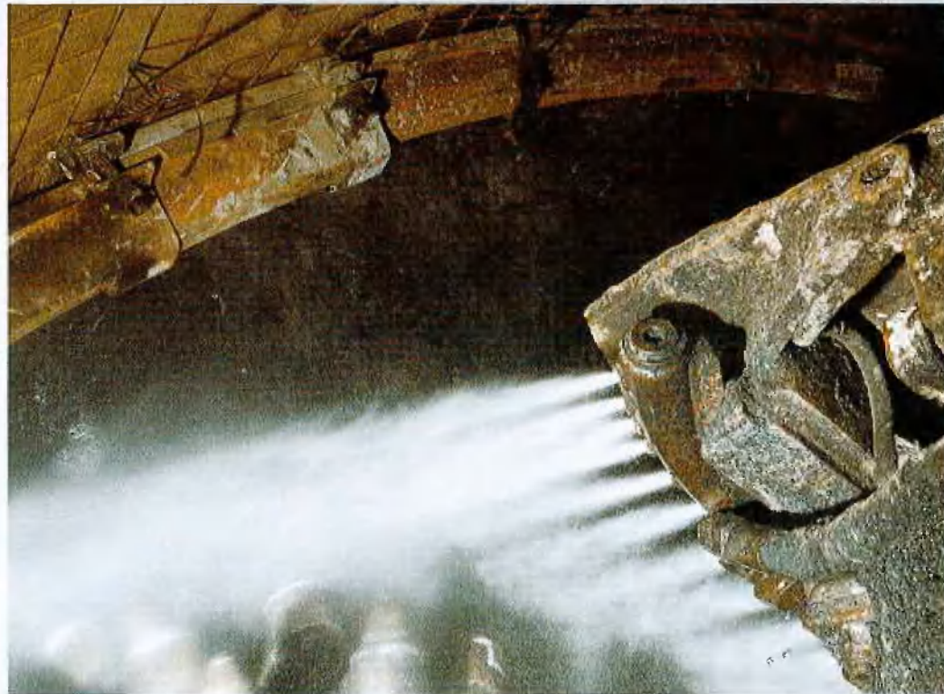
Wassernebel-Bedüsung nach dem Zuschalten von Wasser und Luft
