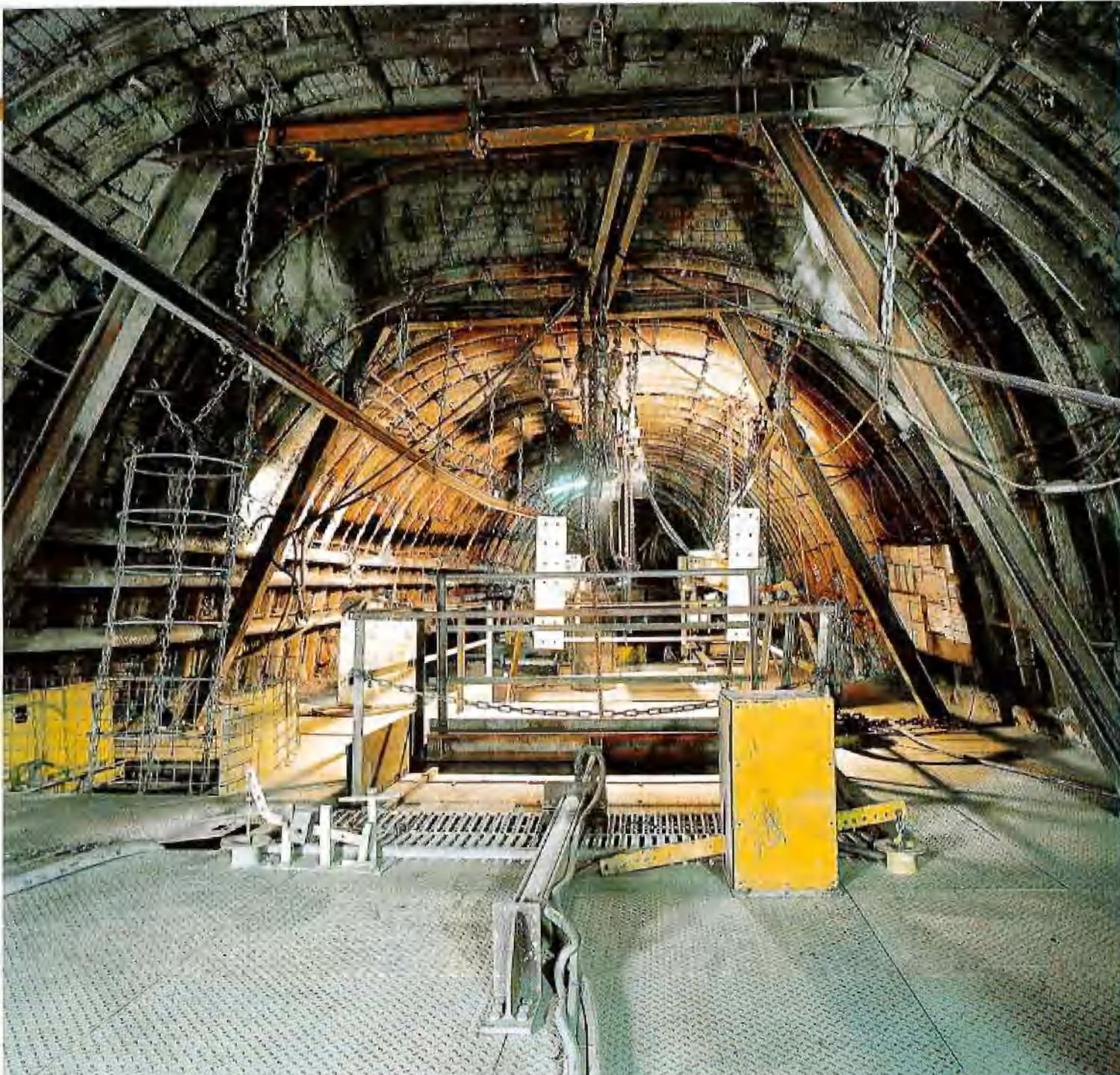
Bunkerkopf mit Schiebeklappe und Rollenkettenverlagerung
