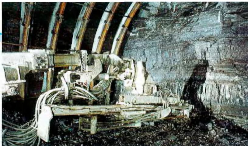
Bohrarm mit Doppeldrehtrieb
