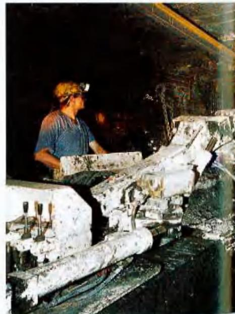
korb aus oder herkömmlich vom Trägergerät aus gesteuert werden. Mehrfach wurden diese Ausführungen mit teleskopierbaren Bohrlafetten ausgestattet, die sowohl radiales Ankern als auch die Erstellung von langen Sprengbohrlöchern ermöglichen.
