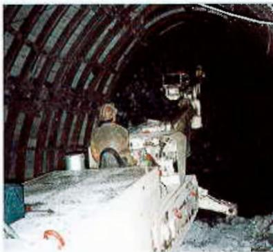
Kompaktbohrwagen im Sprengvortrieb
