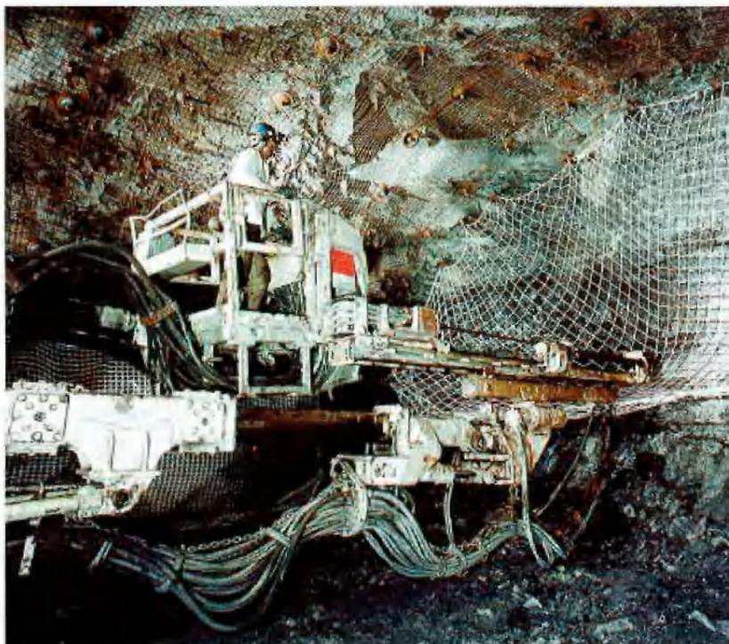
Bohrwagen BTR1-HKL mit Drehbohrmaschine
