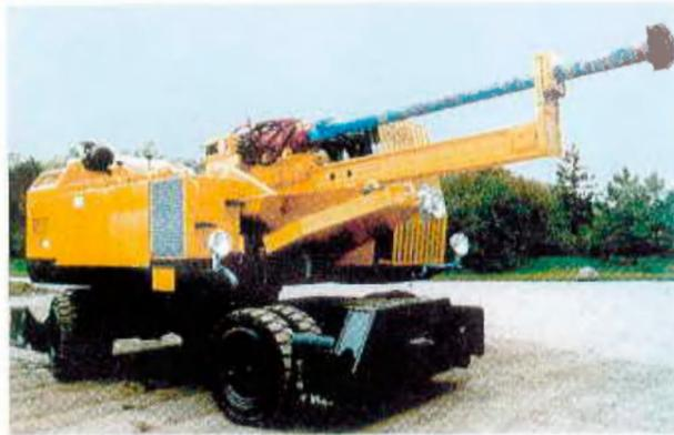
Abstichlochbohrmaschine mit Bohrhammeranlage B 1000 R
